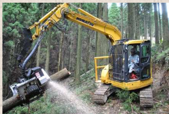
間伐作業(高性能林業機械)
